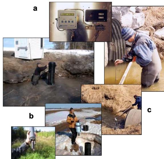
**Figure 3. Dispositif de suivi hydrométrique et de qualité de l'eau incluant le limnimètre et le jaugeage du débit (a), la sonde multi-paramètres à mobilité verticale (b) et l'échantillonnage ponctuel (c).**
