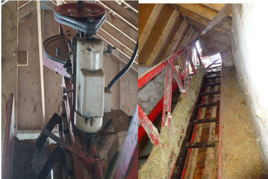
Photo#1 : Système moteur/engrenage et chaîne du l'écurieur
