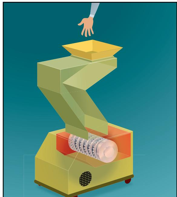
FIGURE 5-10 : BROYEUR DE PLASTIQUE MUNI DE CHICANES
