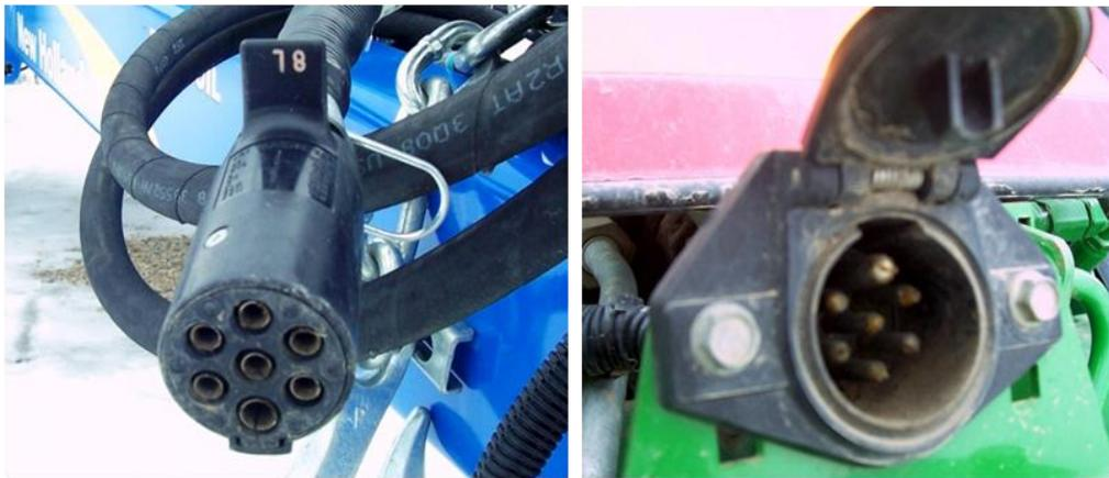
Prise de la remorque (mâle) et connecteur du tracteur (femelle) du connecteur électrique à sept pôles
