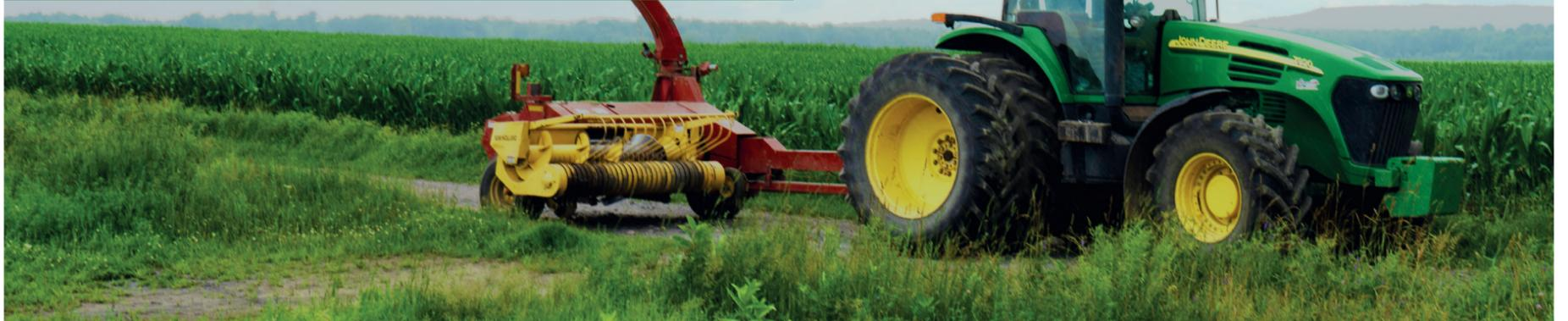
Lors du déblocage et de l'entretien de machines attelées à un tracteur, des accidents graves, voire mortels, surviennent fréquemment. Ceux-ci sont généralement causés par le démarrage intempestif de la machine ou le mouvement soudain de pièces mobiles alors que le travailleur se trouve dans une zone dangereuse.
