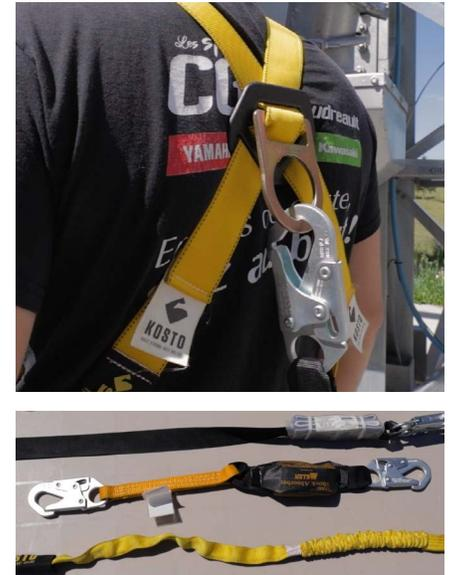
Le coulisseau est raccordé à l'anneau dorsal à l'aide d'un cordon d'assujettissement avec absorbeur d'énergie d'un maximum de 60 cm de longueur.
