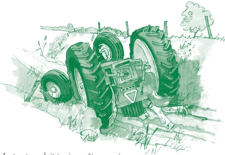
Le tracteur doit toujours être muni d'une SPR et d'une ceinture de sécurité.
