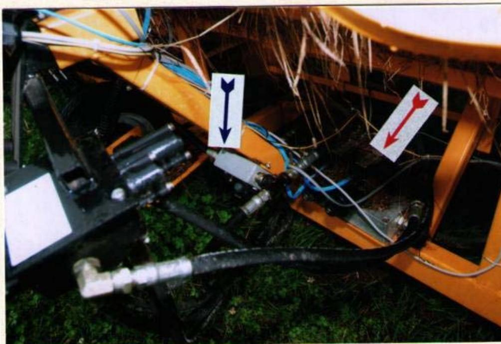
Photo 12 : Vue du côté gauche central de l'enrobeuse; la flèche bleue montre le sélecteur de vitesse de rotation du cerceau et les flèches rouges montrent les valves électriques
