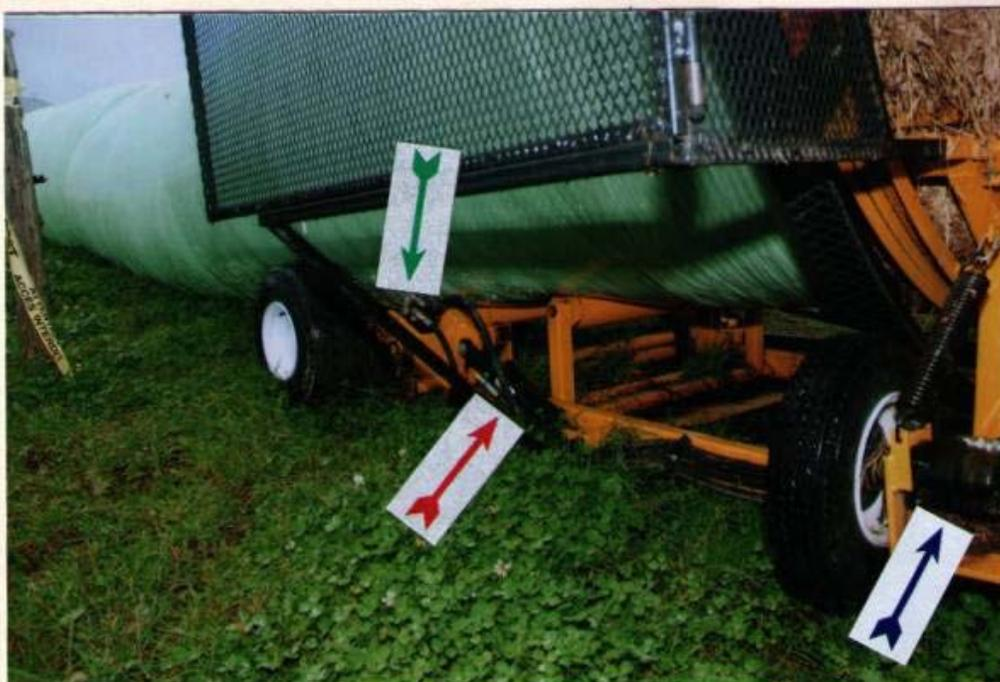
Photo 14 : Vue du côté avant-gauche de l'enrobeuse; la flèche bleue montre le moteur de rotation du cerceau, la flèche rouge montre le vérin hydraulique pour la hauteur du châssis et la flèche verte montre le moteur de traction des roues avant
