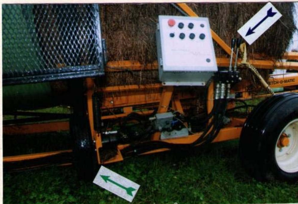
Photo 10 : Portion centrale gauche de l'enrobeuse; la flèche bleue montre les manettes de contrôle (joysticks) et la flèche verte montre la roue d'entraînement du cerceau rotatif
