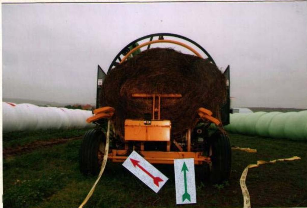
Photo 4 : Autre vue de l'arrière; la flèche rouge montre le vérin hydraulique qui actionne la direction des roues arrière et la flèche verte montre le réservoir d'huile hydraulique
