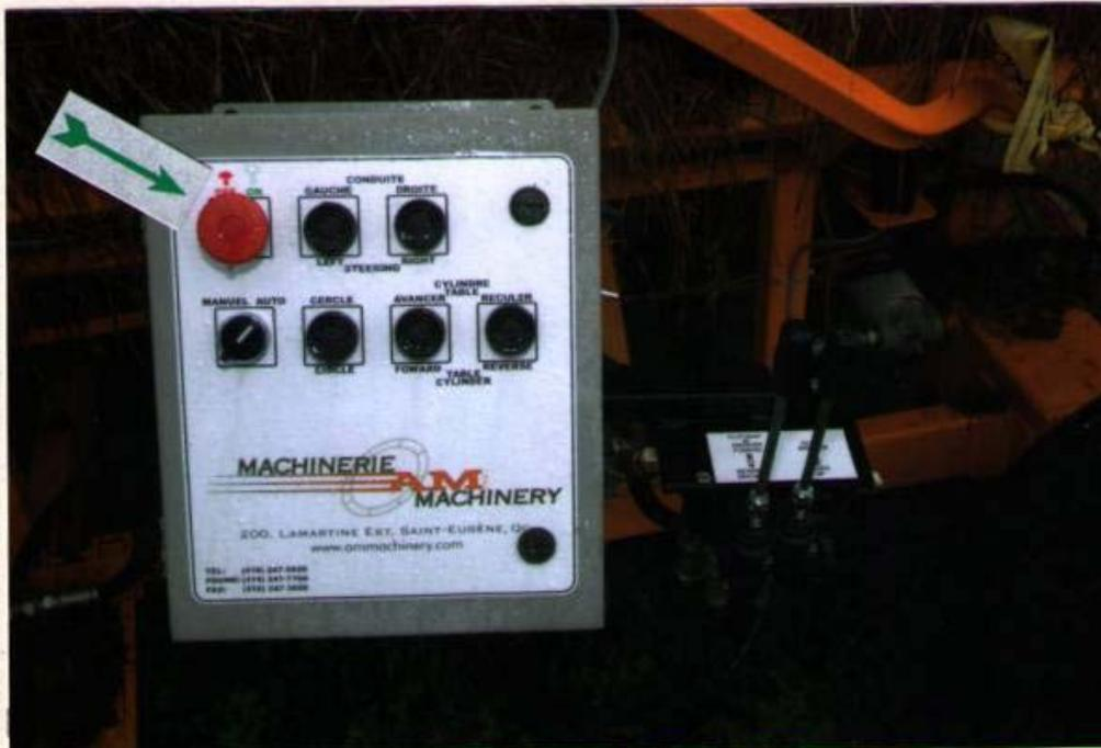
Photo 11 : Vue rapprochée du boîtier de commande et des manettes de contrôle; la flèche rouge montre l'interrupteur principal de ce boîtier
