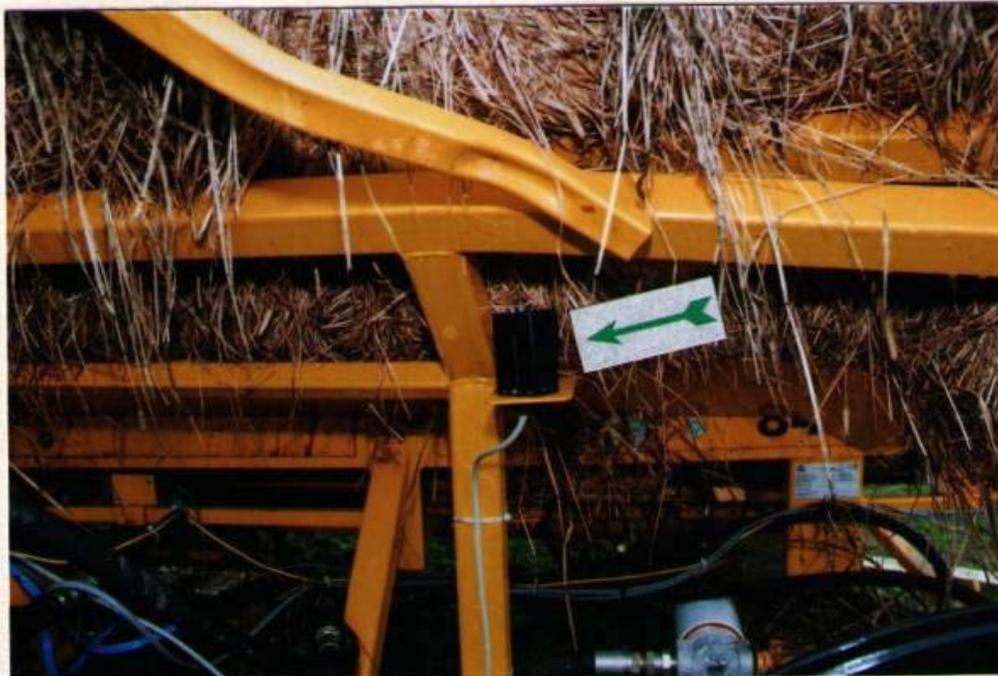
Photo 9 : La flèche montre l'œil magique situé du côté gauche de la plateforme arrière
