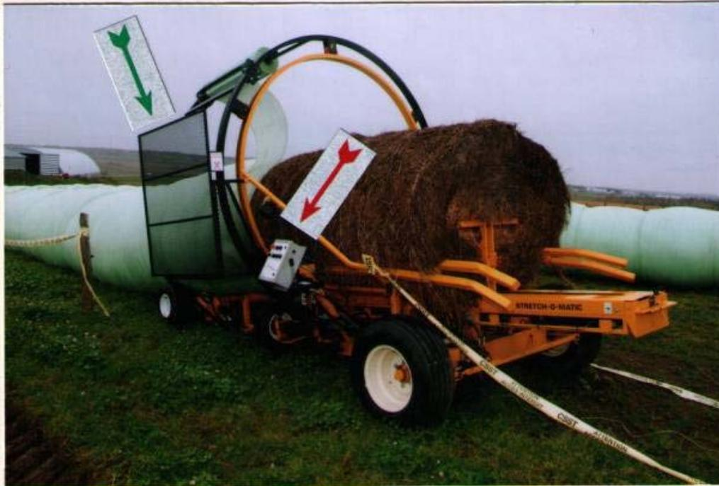
Photo 7 : Arrière et côté gauche de l'enrobeuse; la flèche rouge montre le boîtier de commande et la flèche verte montre un grillage de protection
