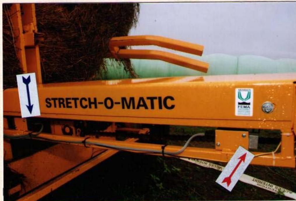
Photo 8 : Vue de l'arrière (côté gauche) de l'enrobeuse; la flèche rouge montre l'interrupteur du début de cycle et la flèche bleue montre l'interrupteur pour activer le cerceau rotatif
