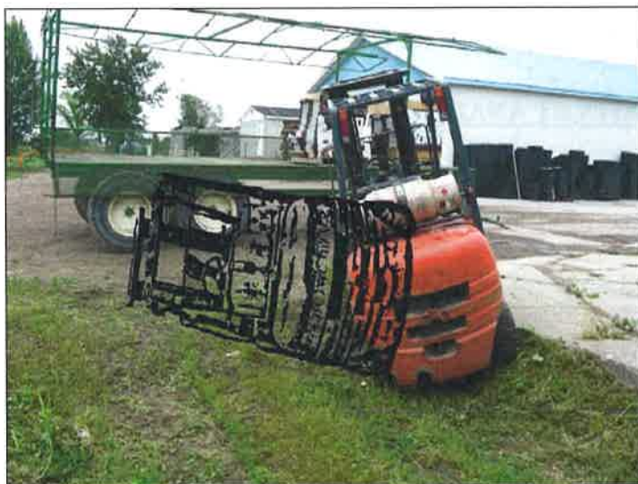
Photo 1 : Chariot élévateur remis sur ses roues après l'accident. La position du chariot élévateur renversé est illustrée en noir. – Source : CSST, modifiée par CSST.
