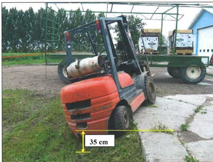
Photo 4 : Hauteur de la dénivellation – Source : CSST.
