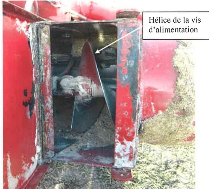
Photo 9 : Vis d'alimentation à l'intérieur du conduit cylindrique (protecteur ouvert)
