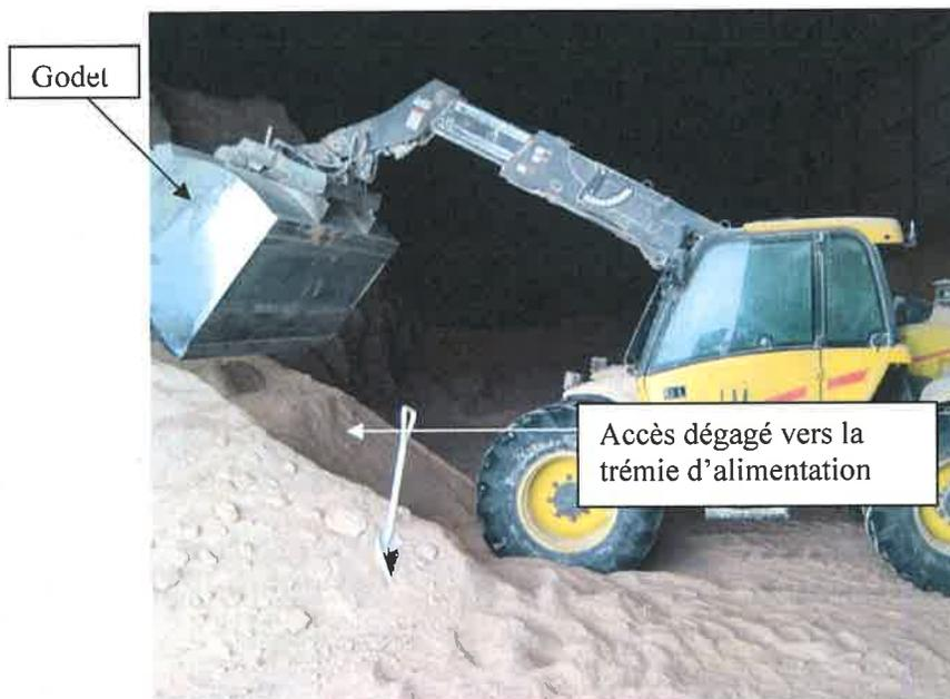
Photo 5 : Chariot élévateur tout terrain devant la trémie d'alimentation
