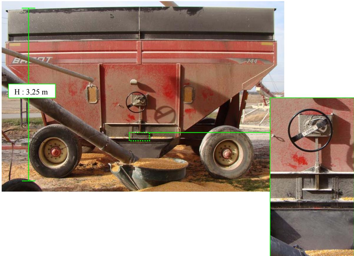
Photo 3 : Porte de déchargement de la voiture à grains
