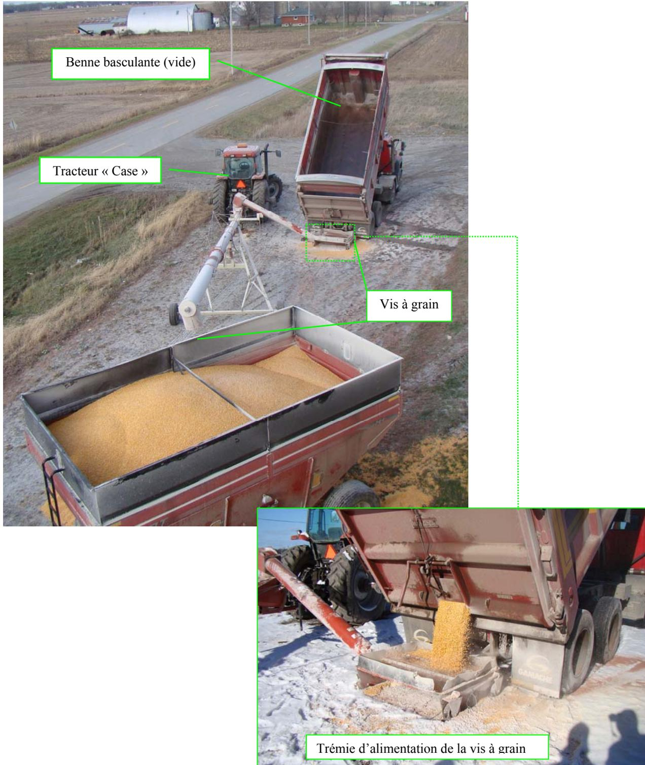
Photo 5 : Mécanisme d'alimentation
