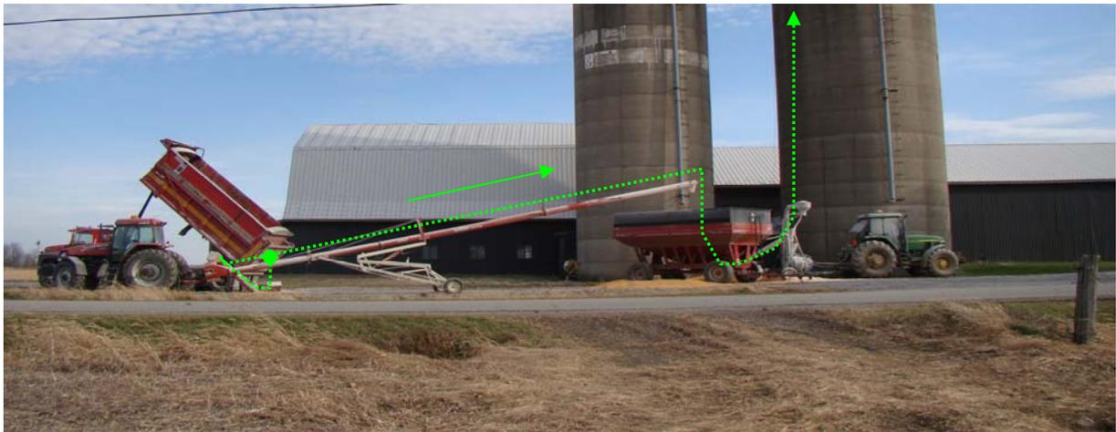
Photo 7 : Parcours du maïs dans les mécanismes
