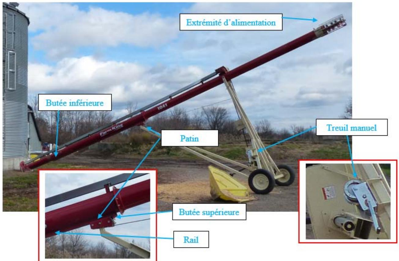
Photo 4 : Mécanisme d'élévation de la vis à grain
