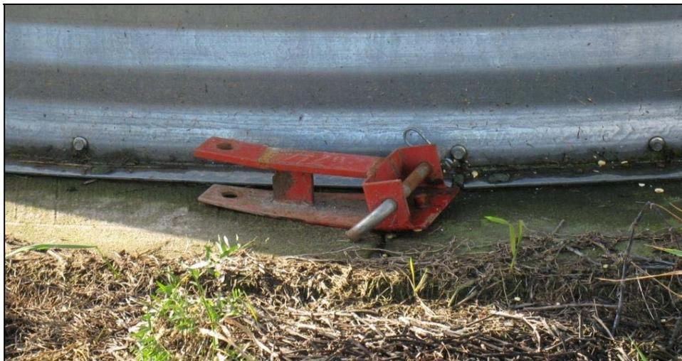
Photo 6 : Attache amovible permettant d'arrimer la vis à grain mobile
