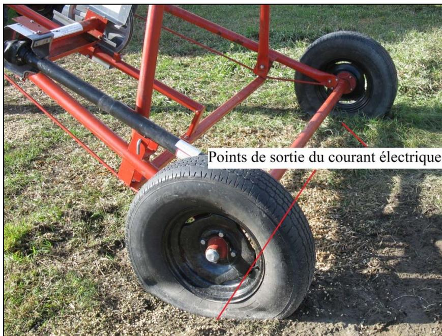
Photo 9 : Points de sortie à la terre du courant électrique par les pneus
