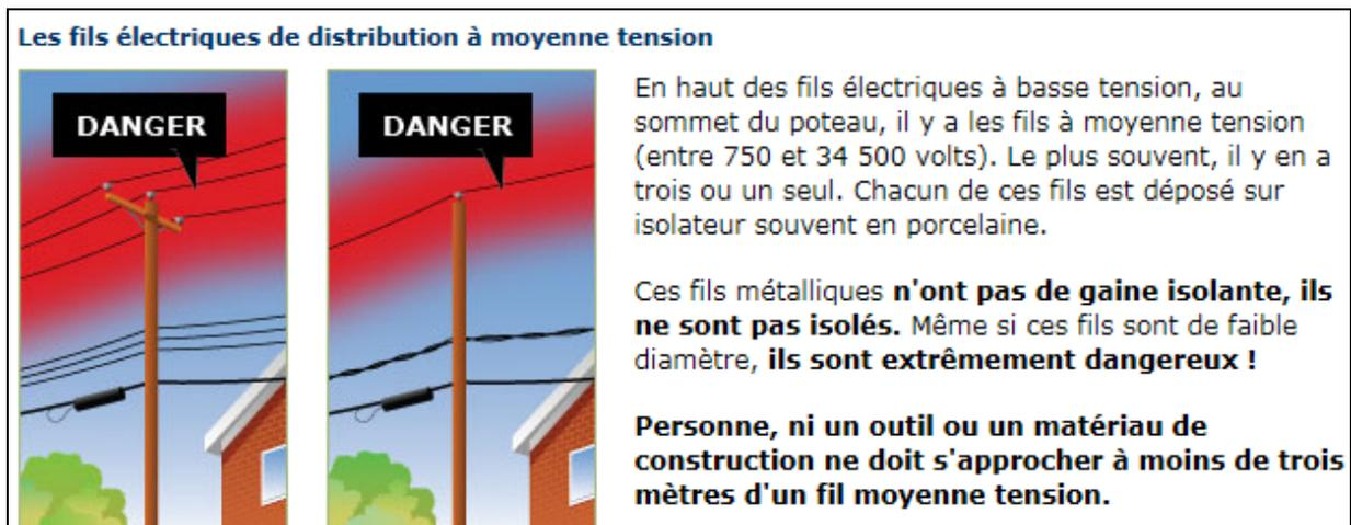
Figure 3 : Extrait des risques de s'approcher de lignes électriques à moyenne tension
