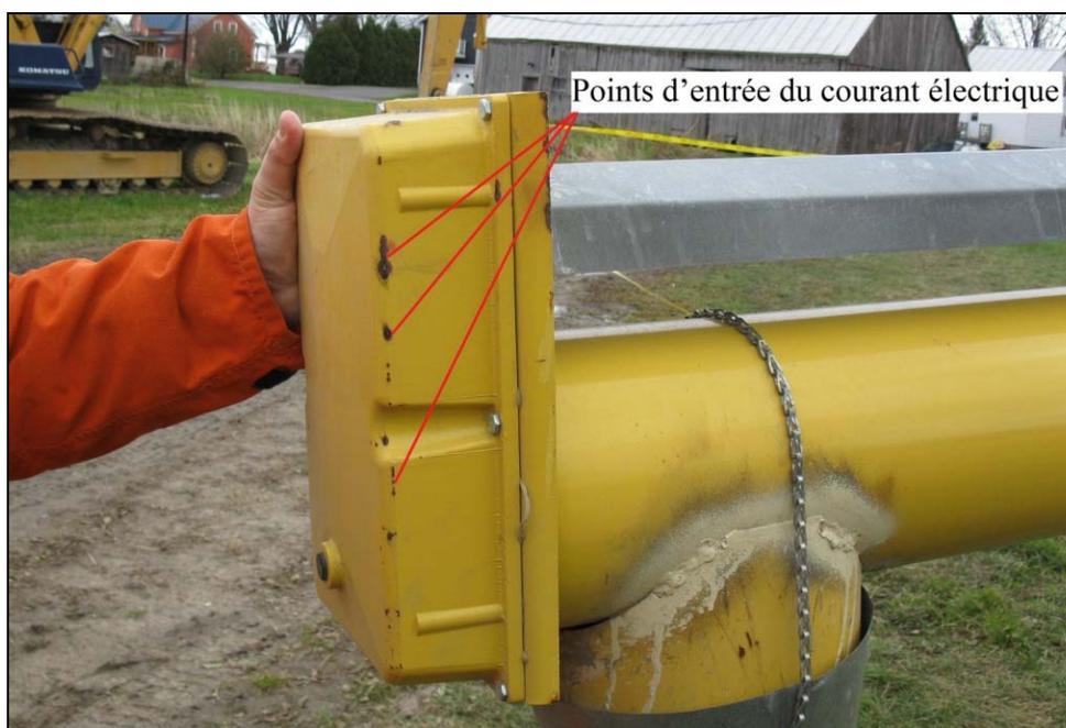
Photo 8 : Points d'entrée du courant électrique sur le protecteur
