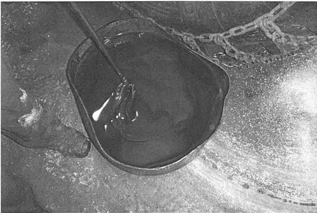
Photo 42 :Vue générale de l'huile hydraulique du véhicule, après sa vidange, montrant qu'elle est très visqueuse et fortement contaminée.
