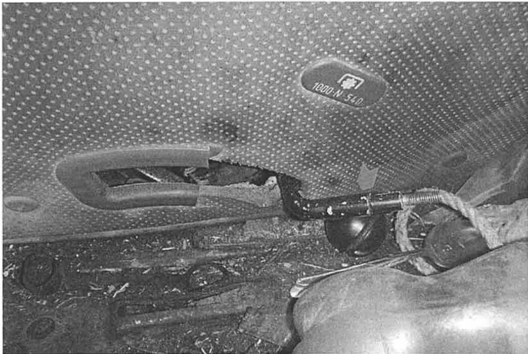
Photo 26 :Vue rapprochée du levier de sélection de vitesse, montrant qu'il est en position 540 RPM.
