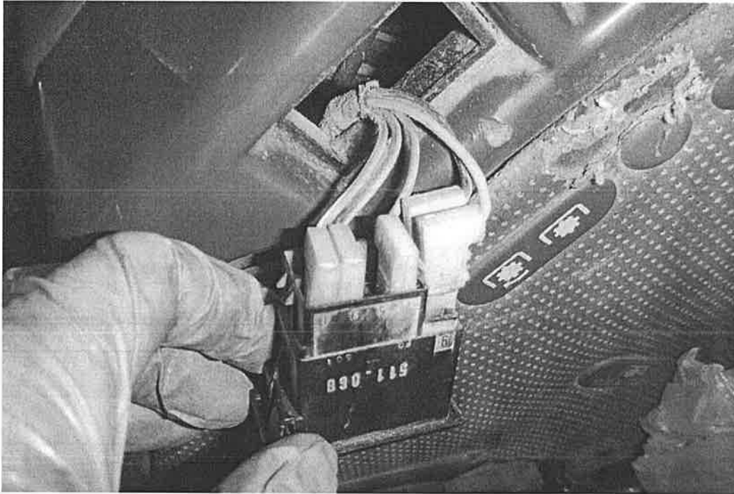
Photo 27 : Vue rapprochée des raccords électriques multi-fiches de l'interrupteur de la prise de force arrière.
