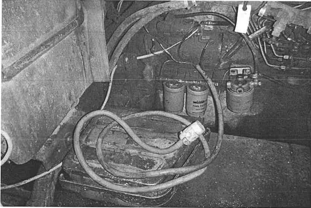
Photo 11 : Vue générale des conducteurs non d'origine du côté droit du compartiment moteur.
