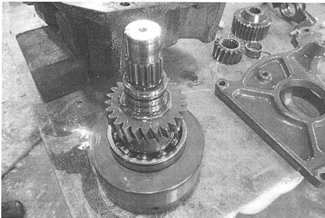
Photo 65 : Vue générale de l'arbre de sortie de l'embrayage de la prise de force arrière, montrant que les engrenages et roulements sont en bon état.
