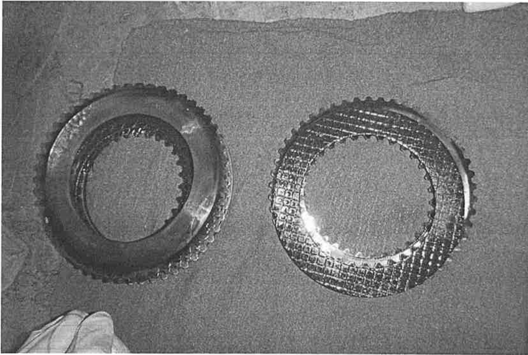
Photo 57 : Vue générale du cinquième disque d'embrayage et de friction, montrant que le disque d'embrayage est partiellement noirci et que le disque de friction est en bon état.
