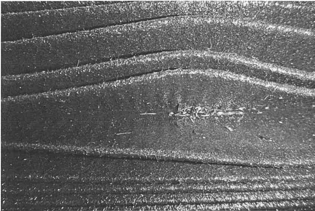
Photo 41 :Vue rapprochée de la photo précédente, montrant la présence de débris métalliques dans le filtre.
