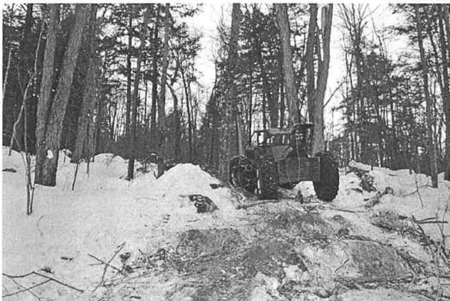
**Photo 3:** Débardeur à câbles utilisé pour transporter les grumes
