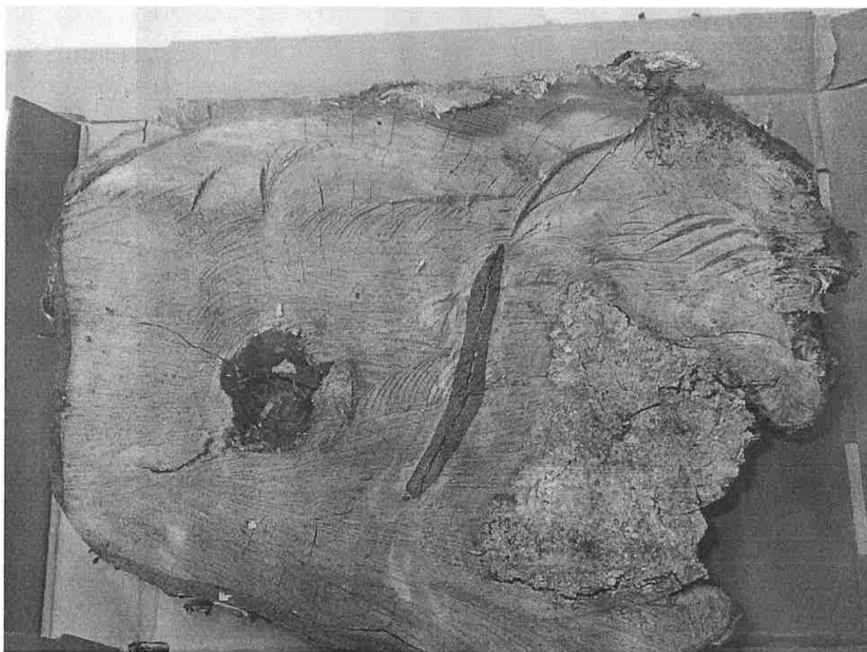
Photo 15: Traits de scie sur la face sciée du tronc du bouleau jaune
