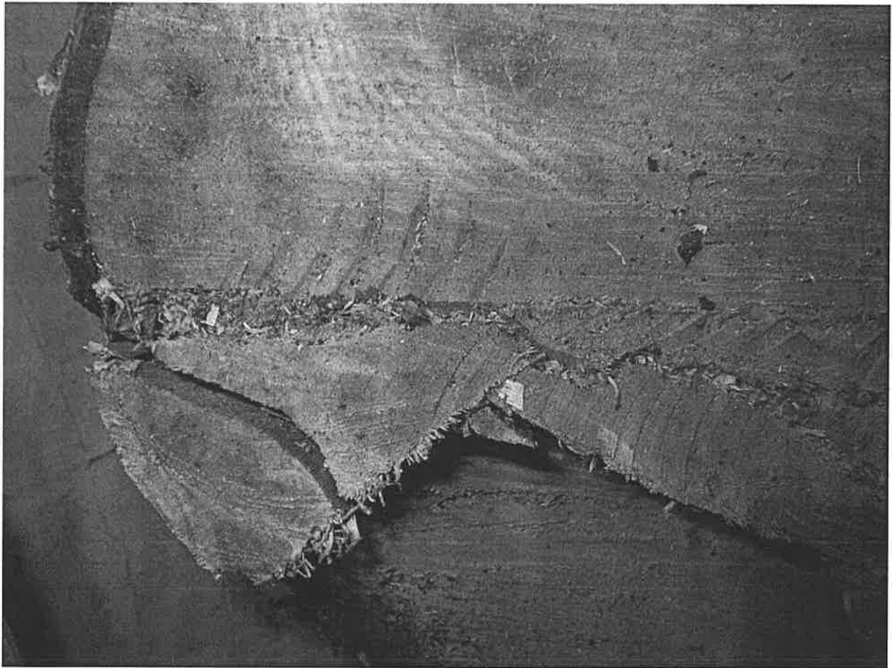
Photo 17: Traits de scie sur la face sciée de la souche à l'endroit où devrait se trouver la charnière
