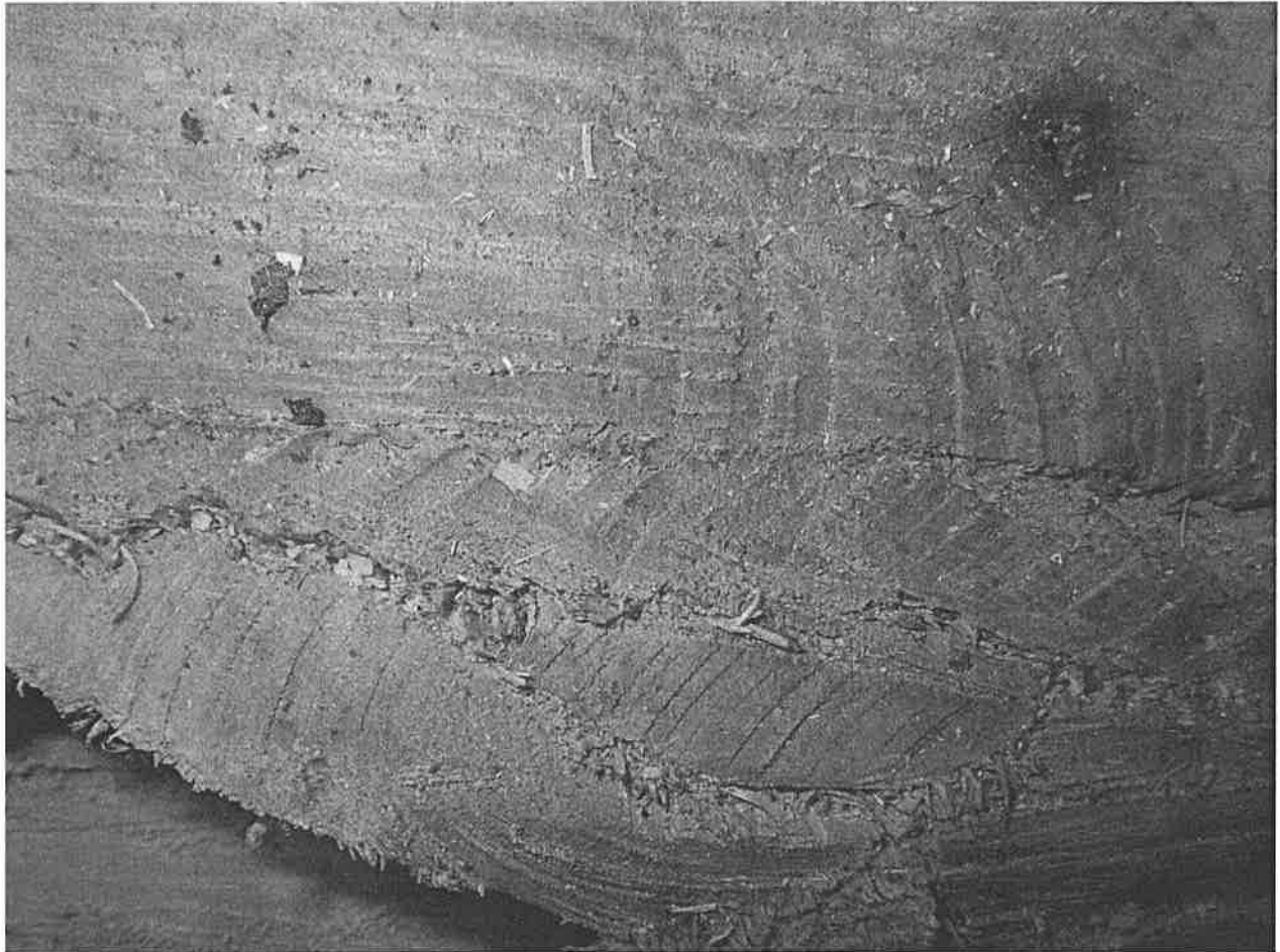
Photo 18: Traits de scie sur la face sciée de la souche à l'endroit où devrait se trouver la charnière Source : CSST
