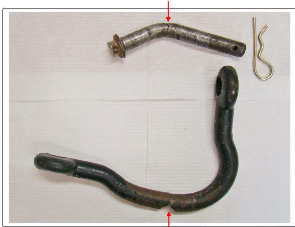
**Photo 4.** Emplacements des amorces de fissures sur les surfaces en tension de la manille et de la goupille avant leur bris (flèches rouges).
