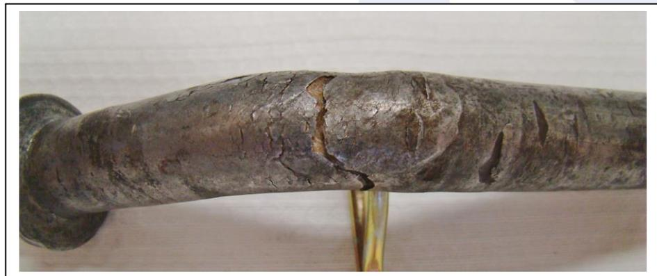
**Photo 6.** Déchirement lent de l'acier par surcharge se traduisant par la formation de multiples fissures adjacentes au bris de la goupille.
