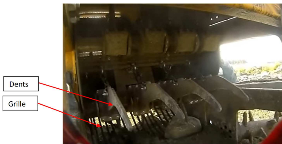
Fig. 7 - Blocage du cueilleur par une pierre Source : Chaîne YouTube d'ELHO, saisie d'écran par CNESST
