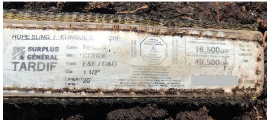
Fig. 8 - Élingue utilisée pour la récupération du tracteur
