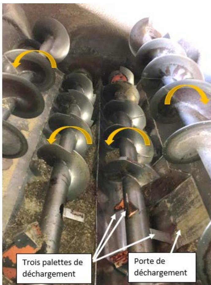
Fig. 8 - Intérieur du mélangeur
