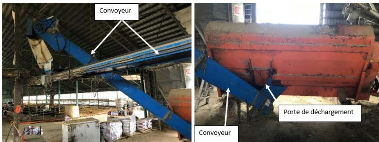
Fig. 5 - *Mélangeur et convoyeurs de distribution*
