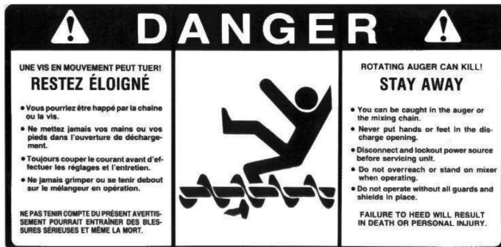
Fig.11 - Étiquette de danger présente sur le mélangeur
