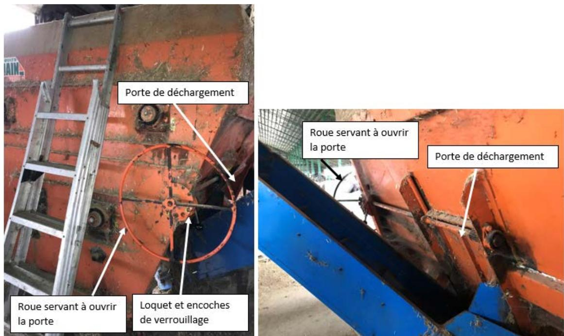
*Fig. 7 - Vue de la roue d'ouverture et de fermeture de la porte de déchargement et de la porte de déchargement. N.B. L'échelle présente sur la figure a été ajoutée après l'évènement.*
